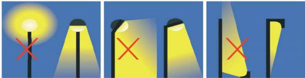
Abbildung 7 Maßnahmen zur punktuellen Beleuchtung von Baustellen (aus SCHMID et al. 2012) (die jeweils rechten Darstellungen entsprechen den Empfehlungen).
