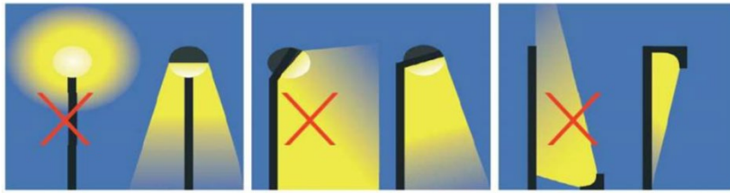
Abbildung 5 Maßnahmen zur punktuellen Beleuchtung von Baustellen (aus SCHMID et al. 2012) (die jeweils rechten Darstellungen entsprechen den Empfehlungen).
